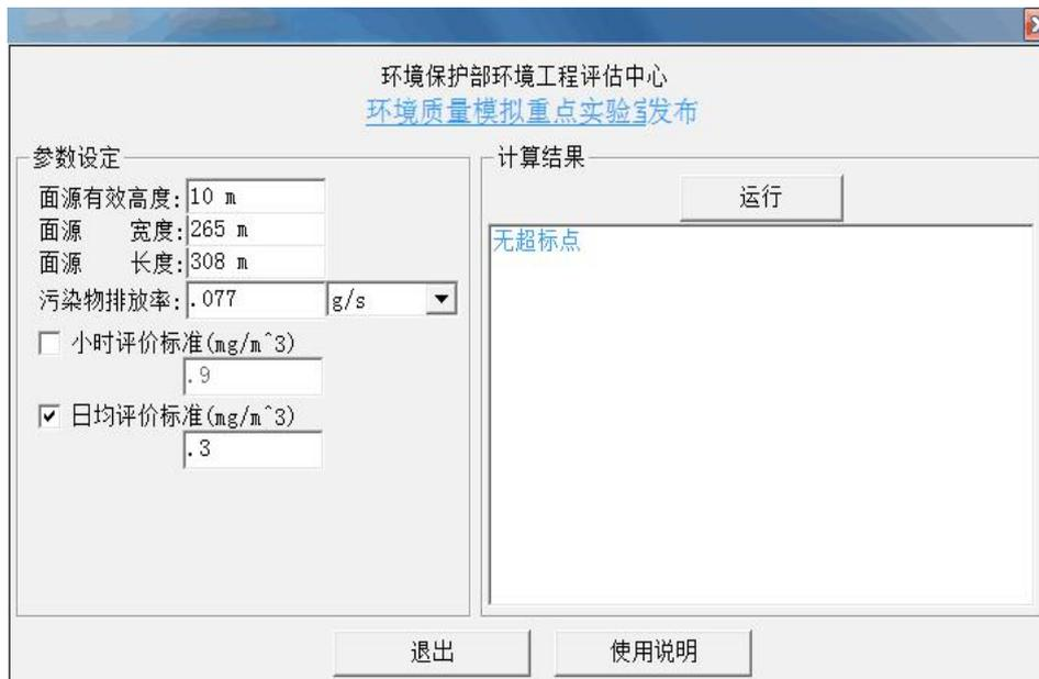
图 7-2 项目大气防护距离计算截图（小班果河矿段矩形面源 TSP）
