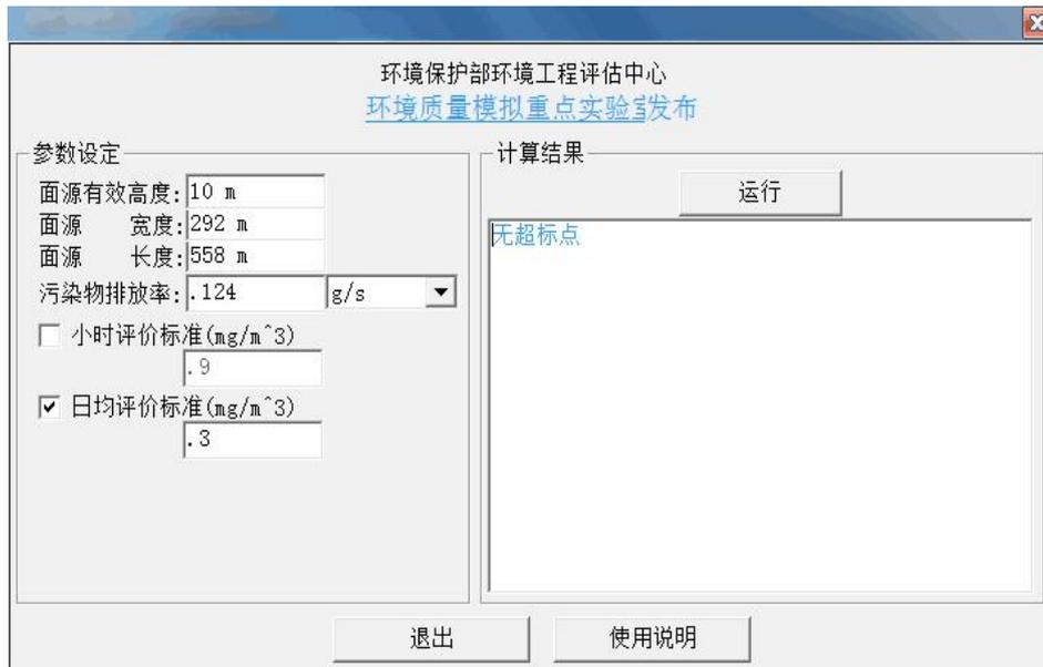
图 7-1 项目大气防护距离计算截图（班果大沟矿段矩形面源 TSP）
