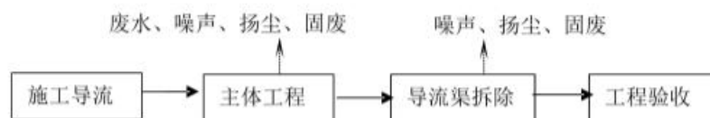
图 2-4 取水坝施工工艺流程
